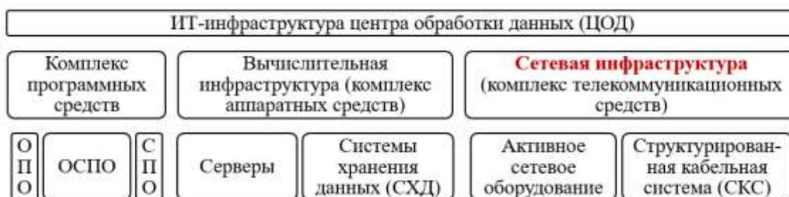
Рис. 1. Состав информационно-телекоммуникационной инфраструктуры центра обработки данных
