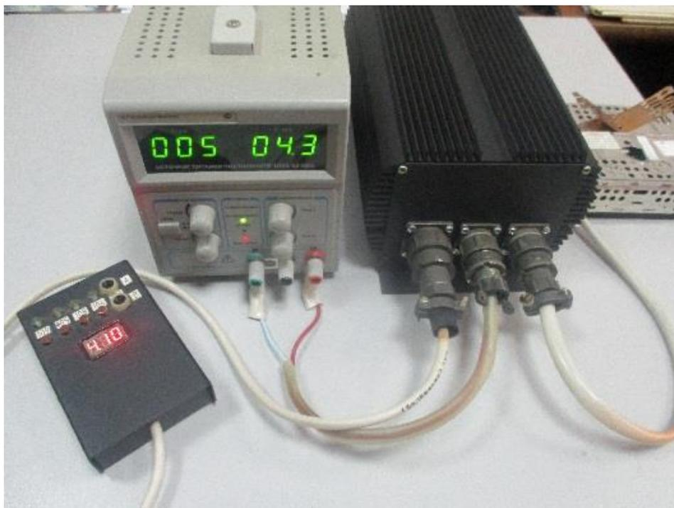
Рис. 9. Внешний вид макета комбинированного накопителя
